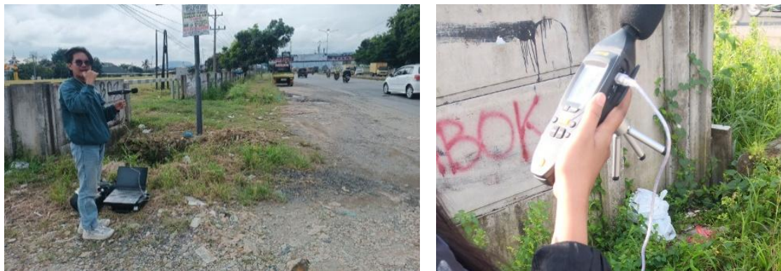
Gambar 3. Pengukuran Kebisingan dengan Sound Level Meter Krisbow Pro
