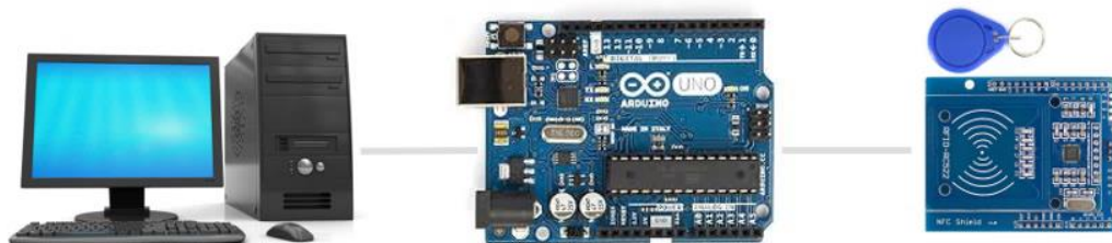
Gambar 5. Diagram Blok Kontrol Sistem Presensi RFID
