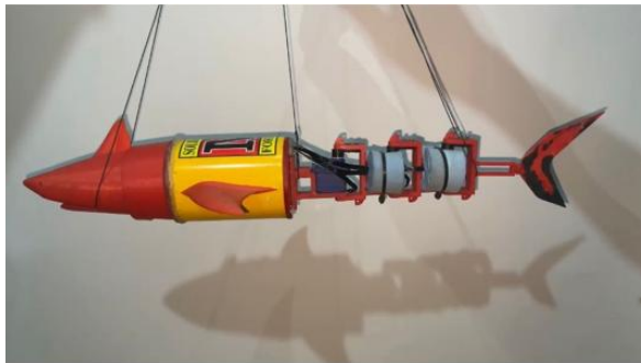
Gambar 6. Pengujian awal (dry testing) sistem kendali robot ikan untuk mengevaluasi respons motor servo dan komunikasi Bluetooth sebelum pengujian di lingkungan air.
