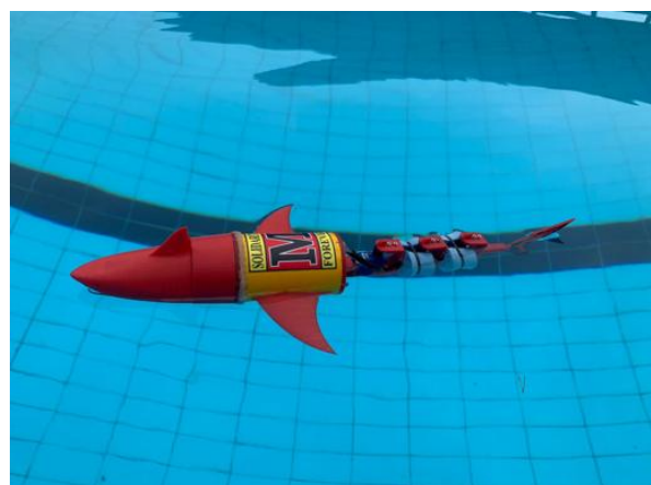
Gambar 8. Pengujian robot ikan pada lingkungan air untuk mengevaluasi performa sistem kendali, stabilitas gerakan, dan kemampuan manuver secara real-time.
