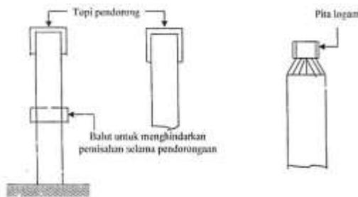
**Gambar 2.7. Sambungan-sambungan tiang pada tiang pancang kayu.**
