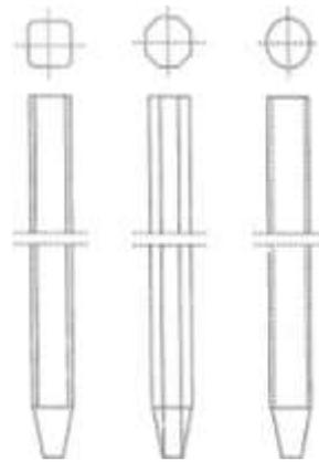
Pondasi tiang pancang beton pracetak digunakan pada kondisi tanah yang tidak memungkinkan untuk mengecor beton di tempat. Jika ruangan tersedia dan sejumlah kwantitas yang diperlukan cukup, pengecoran dapat dilakukan di tempat pembangunan untuk mengurangi biaya transportasi. Pracetak di pabrik dapat mengurangi kebutuhan tempat pembangunan, namun memerlukan peralatan pengangkut tiang pancang dari tempat pembuatan ke tempat pembangunan.
