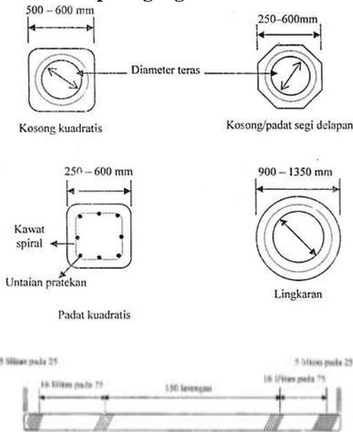
Tiang pancang beton pracetak yang menggunakan penguatan biasa (beton bertulang) dibuat tegangan-tegangan lentur selama waktu pengambilan (*pick up*) dan pengangkutan ke tempat pembangunan untuk momen-momen lentur daripada beban-beban lateral dan untuk menyediakan tahanan yang mencukupi terhadap beban-beban vertical dan terhadap setiap gaya tegangan yang timbul selama pendorongan. Pada gambar dibawah ini
