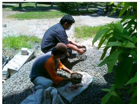
**Gambar 3.** Proses Pengayakan Agregat
