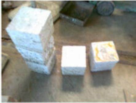
Gambar 12. Beton yang telah di rendam air sulfat.
