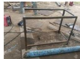
Gambar 2.6 Rangka Mesin
