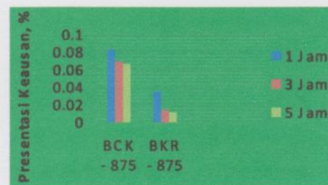
Grafik : Perbandingan presentasi keausan pada BCK dan BKR Dengan temperatur boronisasi 875°C
