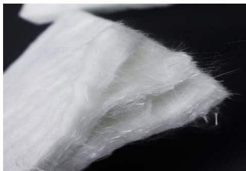
Gambar 1. Needle Mat adalah material isolasi berbentuk lembaran serat yang didapatkan menggunakan metode needle punching.
