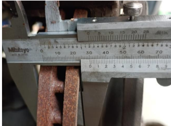
Gambar 1. Repair Manual all New Kijang Innova. Mengukur Run Out pada piringan cakram depan
