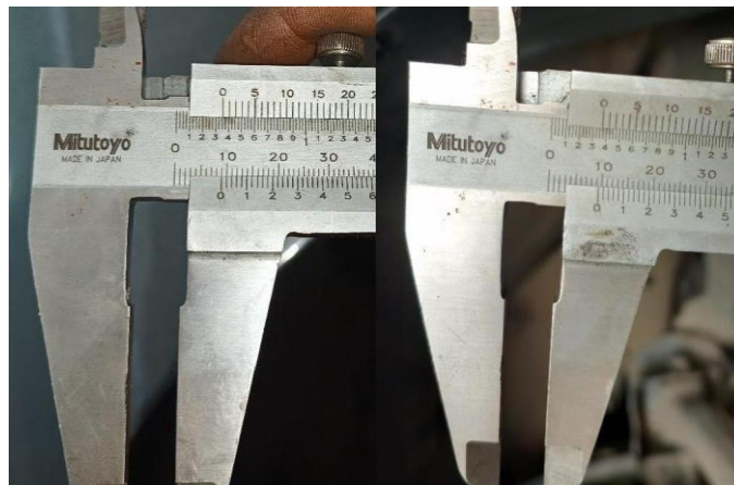
Gambar 3. Pengukuran tebal cakram rem ( disc brake )
