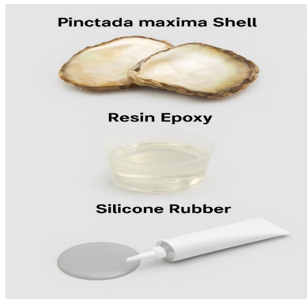
Gambar 1. Material penelitian yang digunakan dalam pembuatan komposit, terdiri atas cangkang kerang mutiara ( Pinctada maxima ) sebagai bahan penguat, resin epoxy sebagai matriks utama, dan silicone rubber sebagai bahan tambahan untuk meningkatkan elastisitas serta ketangguhan material..
