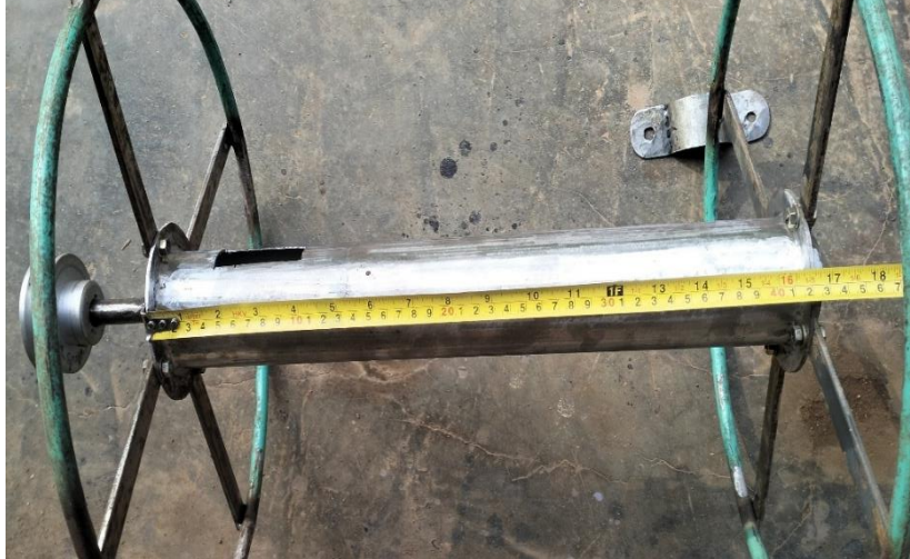
Gambar 1. Pipa Besi kes Untuk Penggulung dengan diameter lubang 48mm, panjang 43 cm dan tebal 2,5 mm
