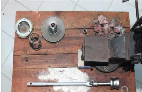
**Gambar 3.** Proses pembongkaran komponen CVT pada sepeda motor Honda Beat PGM-FI untuk penggantian roller dan pegas dalam pengujian
