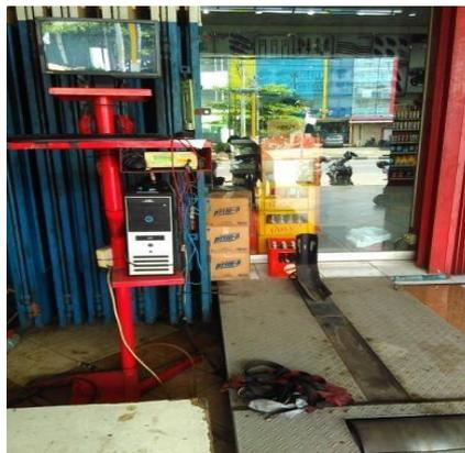
**Gambar 1.** Dynamometer yang digunakan untuk mengukur daya dan torsi sepeda motor Honda Beat PGM-FI dalam penelitian ini
