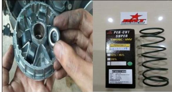
**Gambar 2.** Roller dan pegas CVT yang digunakan dalam pengujian, termasuk roller standar 12 gram, roller balap 9 gram, dan dua variasi pitch pegas: 26,7 mm dan 27,3 mm.
