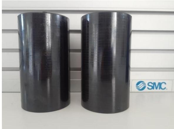
**Gambar 1.** Baja pejal yang digunakan sebagai variasi beban pada sistem hidrolik, dengan berat masing-masing 15 kg dan 30 kg.
