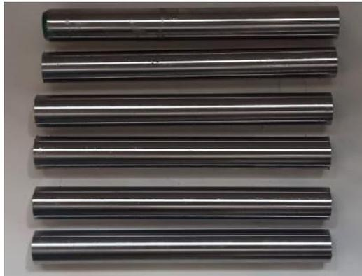
**Gambar 1.** Spesimen baja karbon sedang S45C yang digunakan dalam pengujian tarik. Spesimen ini dibuat sesuai dengan standar ASTM E8 untuk memastikan kesesuaian dalam pengujian kekuatan tarik.
