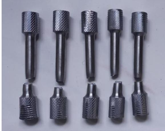
**Gambar 6.** Spesimen baja karbon sedang S45C setelah uji tarik.
