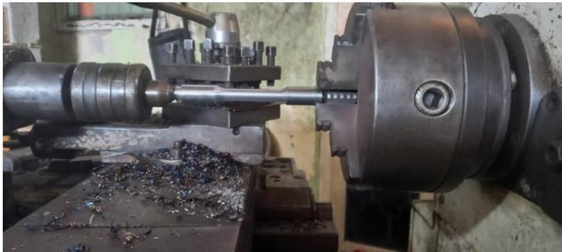
**Gambar 5.** Proses pembuatan spesimen baja karbon sedang S45C menggunakan mesin bubut. Tahap ini memastikan spesimen memenuhi spesifikasi standar pengujian tarik.
