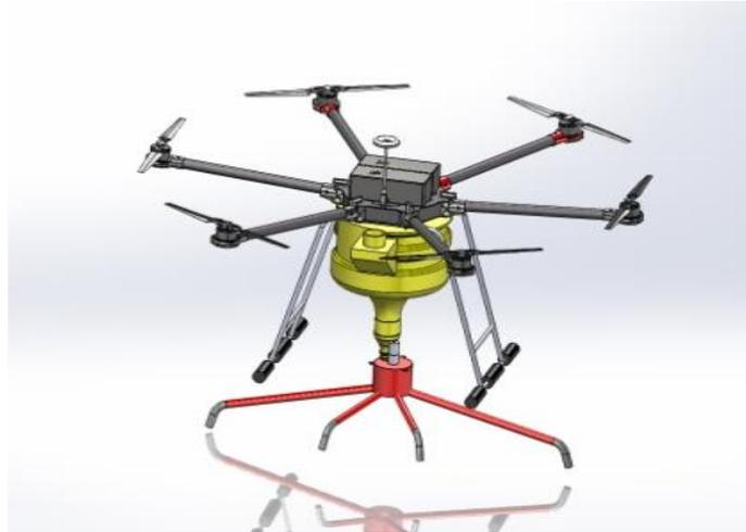
**Gambar 2.** Desain Drone Penebar Benih
