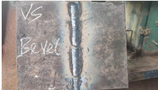
Gambar 5. Hasil proses pengelasan 3G pada spesimen baja ASTM A36 menggunakan metode Shielded Metal Arc Welding (SMAW) dengan kampuh V tunggal dan X tunggal.
