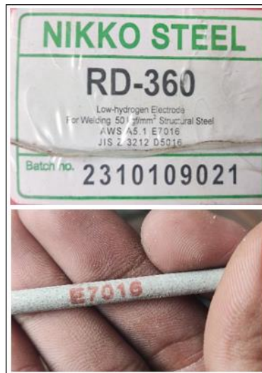
Gambar 1. Elektroda RD-360 AWS A5.1 E7016 yang digunakan dalam proses pengelasan Shielded Metal Arc Welding (SMAW) pada penelitian ini.
