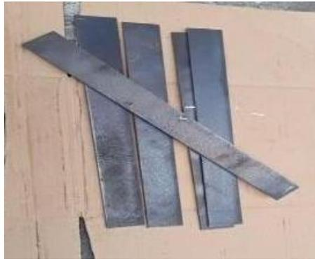
**Gambar 1.** Plat Baja st 37 Ketebalan 5mm, yang digunakan sebagai bahan uji dalam penelitian pengelasan.
