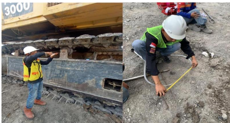
Gambar 2. Proses pengukuran top roller menggunakan outside caliper
