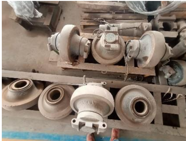
Gambar 1. Top Roller dari Excavator Komatsu PC SE 3000 yang berfungsi untuk menopang track link dan menjaga kestabilan pergerakan track. Komponen ini mengalami keausan akibat kontak terus-menerus dengan track link dan tanah, sehingga memerlukan pemantauan rutin untuk mencegah kerusakan yang lebih parah..
