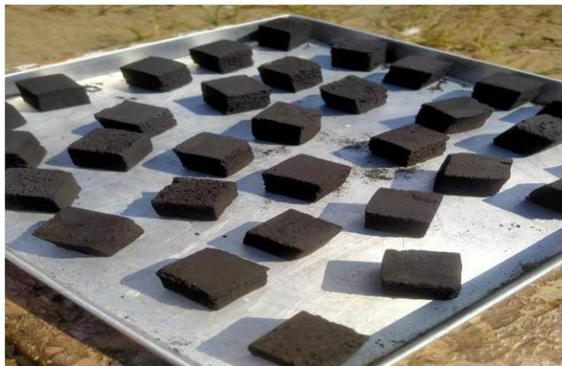
**Gambar 3** Hasil Pembuatan Briket Caroxide
