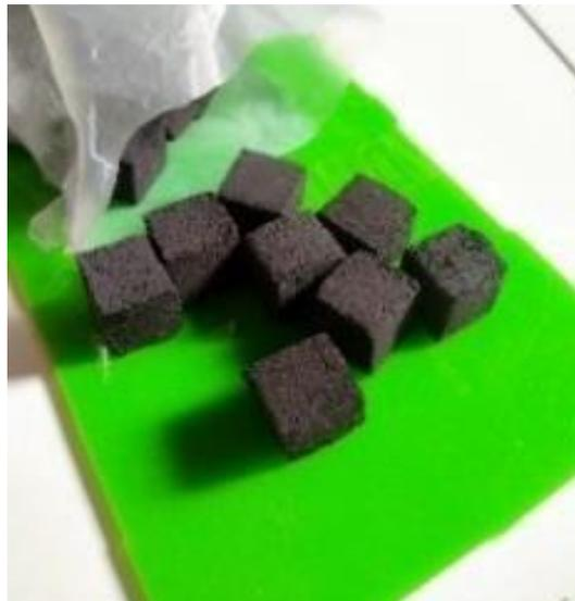
**Gambar 1.** Briket Caroxide, yang digunakan sebagai bahan bakar pada tungku biomassa, terdiri dari 92,5% arang tempurung kelapa, 2,5% tapioka sebagai perekat, dan 5% hidrogen peroksida ( $H_2O_2$ ). Briket ini menunjukkan nilai kalor tinggi dan efisiensi pembakaran yang optimal.
