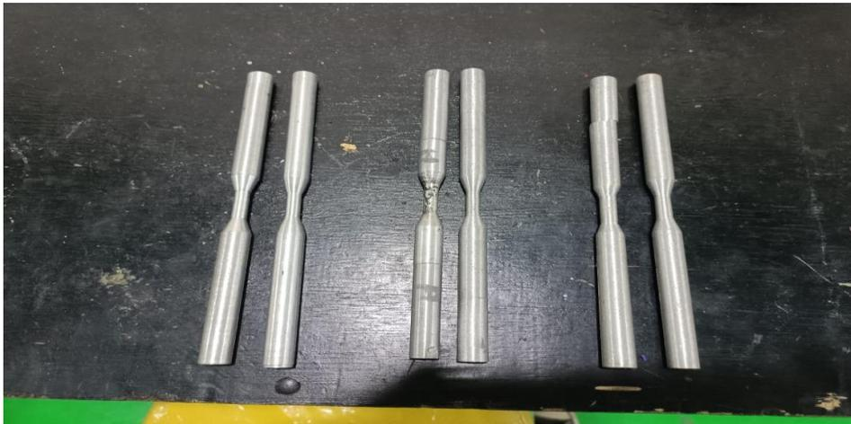
**Gambar 4.** Hasil proses Pembubutan Spesimen Aluminium. Spesimen ini dibentuk sesuai dengan standar ASTM untuk persiapan pengujian tarik dan fatigue, guna mengevaluasi pengaruh penambahan mangan terhadap sifat mekanik material.
