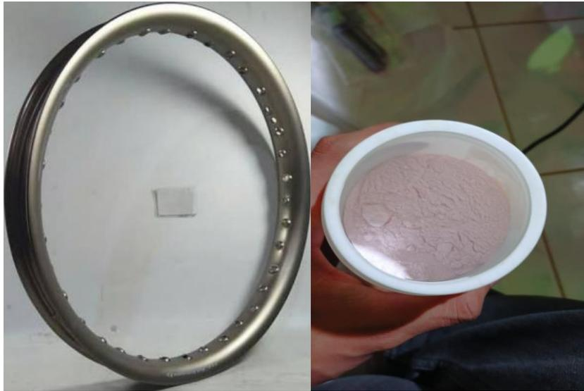
**Gambar 1.** Velg Bekas dan Bahan Mangan (Mn) yang digunakan sebagai bahan utama dalam penelitian ini. Velg dilebur untuk diolah menjadi spesimen aluminium, sementara mangan ditambahkan dalam berbagai konsentrasi untuk menilai pengaruhnya terhadap sifat mekanik dan ketahanan fatigue material
