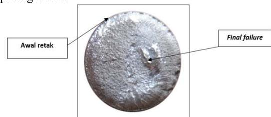
**Gambar 10. Permukaan patahan yang terjadi akibat tegangan 182,5 MPa**
