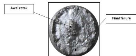
**Gambar 9. Permukaan patahan yang terjadi akibat tegangan 219 MPa**
