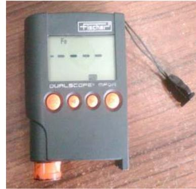
Gambar 16. Alat Uji Ketebalan Lapisan
