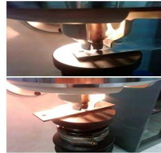
**Gambar 18. Pengujian Kekerasan Brinell (HB)**
