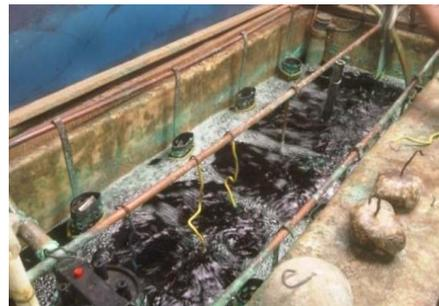
Gambar 8. Bak Larutan Elektrolit Untuk Proses Pelapisan *Nikel*
