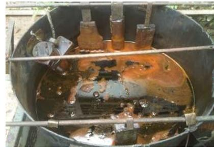
Gambar 9. Bak Larutan Elektrolit Untuk Proses Pelapisan *Chrome*
