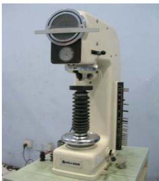
Gambar 15. Alat Uji Kekerasan Brinell (HB)
