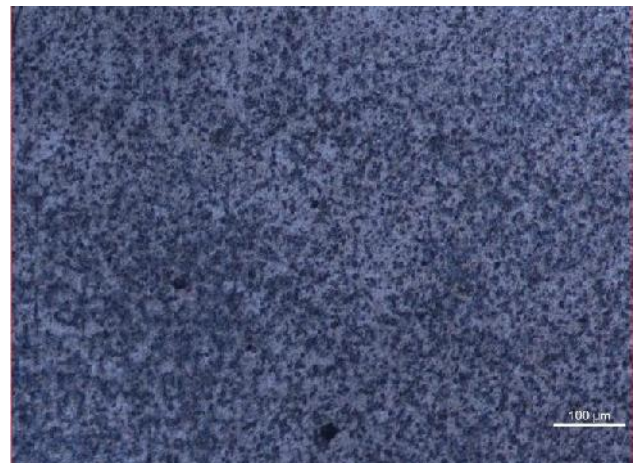
Gambar Las (Proses Perlakuan Panas 750 0 c)
