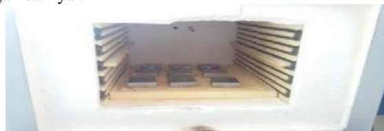
Gambar 3.8. Spesimen uji didalam furnace
