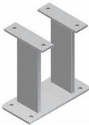
Gambar 8. Dudukan pully dan roda amplas
