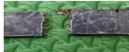
Gambar. 32 Foto patahan spesimen uji tarik serat acak
