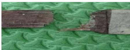
Gambar.28 Foto patahan spesimen uji tarik serat lurus
