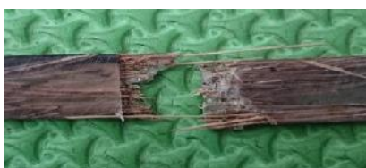
Gambar.29 Foto patahan spesimen uji tarik serat lurus
