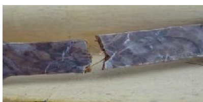
Gambar. 30 Foto patahan spesimen uji tarik serat acak
