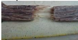
Gambar.27 Foto patahan makro spesimen uji tarik serat lurus
