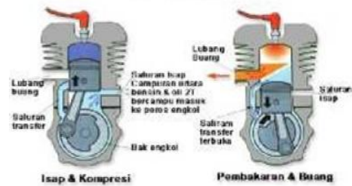
Gambar Prinsip kerja motor bakar bensin 2-langkah; (a) langkah hisap dan Gambar Prinsip kerja motor bakar bensin 2-langkah; (a) langkah hisap dan kompresi; (b) langkah daya dan buang.
