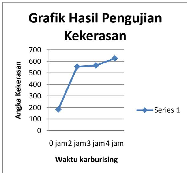
Gambar grafik Nilai Kekerasan permukaan rata-rata . Grafik pada gambar 4.3 menunjukkan nilai kekerasan permukaan benda uji. Jika kita perhatikan grafiknya, perlakuan panas karburising sangat mempengaruhi kekerasan permukaan benda uji. Benda uji ke 1 atau bahan dasar yang tidak mendapat perlakuan panas karburising nilai kekerasannya hanya
