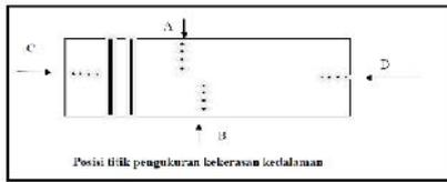
Gambar skema titik pengujian kekerasan dengan jarak dari tepi= 150 mikron
