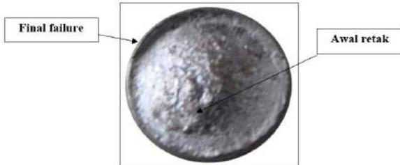
**Gambar 11 .** Permukaan patahan yang terjadi akibat tegangan 146 MPa
