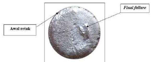
**Gambar 10 .** Permukaan patahan yang terjadi akibat tegangan 182,5 MPa
