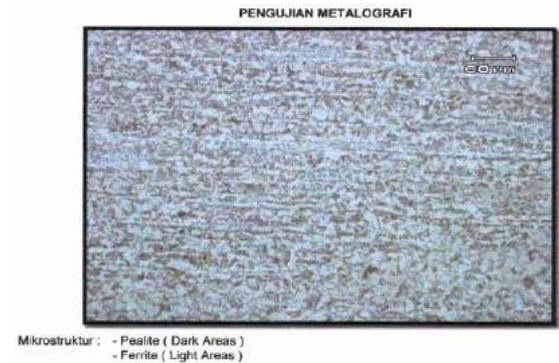
**Gambar 4.1 Struktur Mikro Spesimen awal baja Hardox. Pembesaran 500x**
